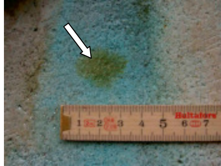
Abb. 10: Reaktive Substanzen wie z.B. Wasserstoffperoxid können ungeahnte Farbveränderungen (Pfeil) auf der Oberfläche zur Folge haben, wenn sich darin metallische Spurenelemente (hier Kupfer) befinden.
