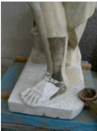
Abb. 14: Detail einer klassizistischen Marmorskulptur aus dem Park Sanssouci, Potsdam. Die obere Hälfte des Beins ist lasergereinigt. Die untere Hälfte weist noch die dunklen Schmutzablagerungen auf.
