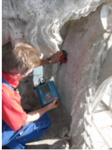
Abb. 15: Messungen zur Armierungsdetektierung in die Rückseite des Wappenschildes mit dem Profometer 5 + . Erstaunlicherweise wurden keine Bewehrungen geortet.
